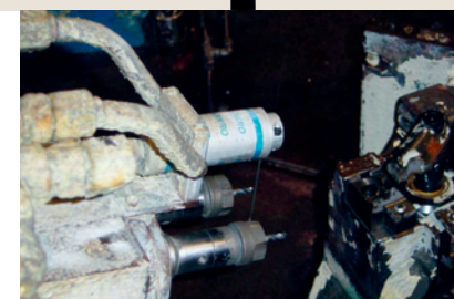
TK94A / TK94RL 主に(自動)旋盤、小型工作機械用、 回転工具の検出に最適です。
