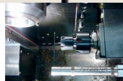
TK96A / TK96RL 主に(自動)旋盤、小型工作機械用、 回転工具の検出に最適です。
