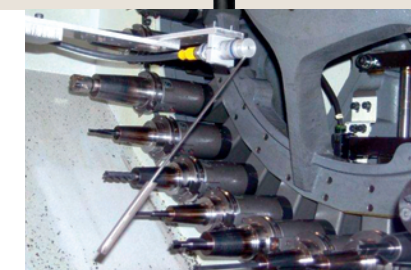
TK8A 主にマシニングセンタ用、 長尺工具の検出に最適です。
